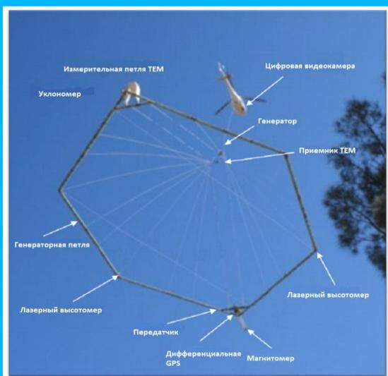
Рисунок 1: Краткий обзор системы SkyTEM<sup>508</sup>
